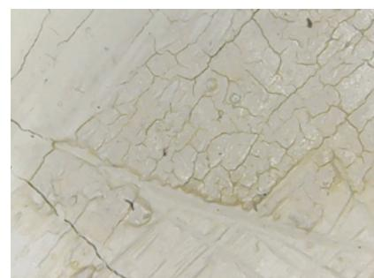
**Fig. 9.** Détail sous microscope digital des craquelures caractéristiques de la peinture blanche n°3 liée à la colle animale. © Chiara Bianchi.
