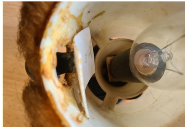
**Fig. 10.** Traces de colle et nez décollé, intérieur de la lampe DG.2015.93. © Lisa-Clémentine Guillou.
