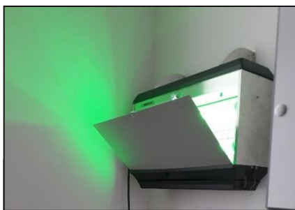
◀▼ Pièges à lumière verte (sans UV) en réserve et à lumière bleue (avec UV) en espace d'exposition
