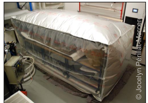
▲ Traitement par anoxie dynamique par balayage d'azote en surpression dans une poche étanche réalisée sur mesures
