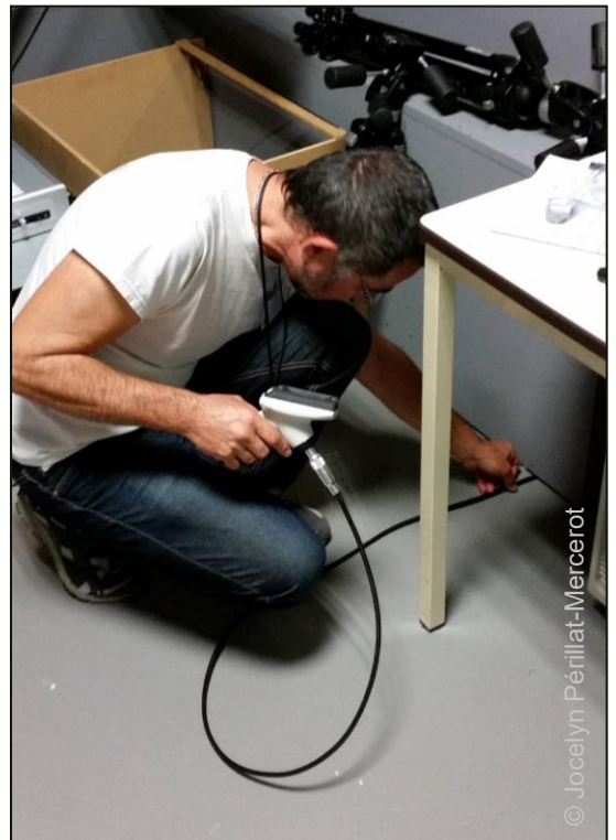
▲ Inspection avec un endoscope pour rechercher des insectes à l'intérieur de coffrages techniques
