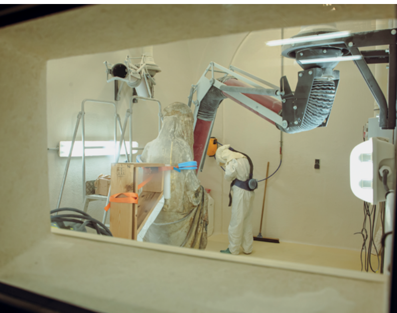
Une cabine de micro-sablage des ateliers du C2RMF, Pavillon de Flore, Paris. ©C2RMF - A. Merlet
