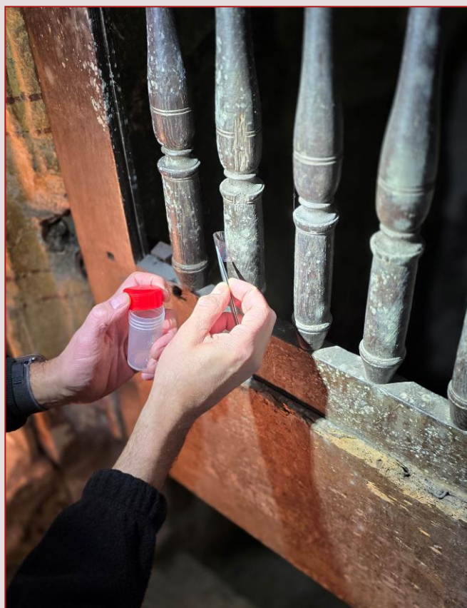
Étude et prélèvement par bande adhésive de micro-organismes se développant sur du mobilier en bois © LRMH / Faisl Boustia
