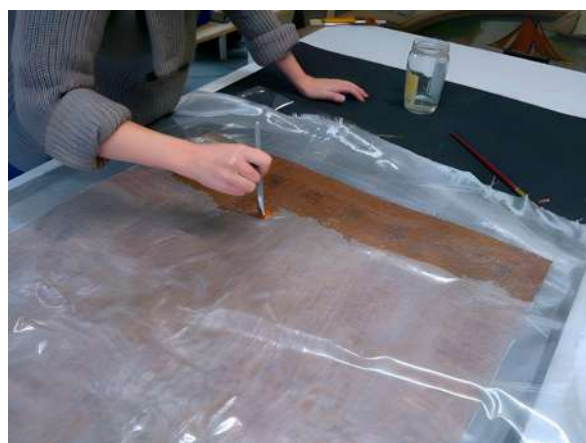
Fig. 7. Application préalable d'une interface en tissu de fibre de verre au revers du métal. © Laurence Mugniot.
