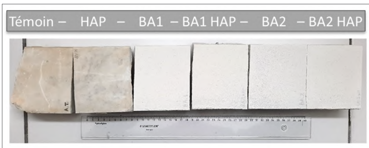
Fig. 14. Photographies des éprouvettes. De gauche à droite : témoin non traité, traitement HAP, formulation BA1, formulation BA1 HAP, formulation BA2, formulation BA2 HAP. © Azzurra Palazzo.
