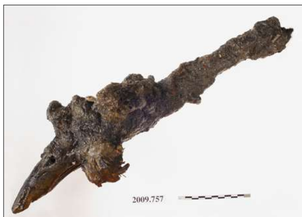
Fig. 7. Pistolet provenant de l'épave de la Lomellina, avant traitement. Une épaisse gangue de concrétions ferreuses enserre tout le mécanisme d'armement et le canon, disparus, ainsi que la partie en bois, bien conservée. © Jean-Gabriel Aubert/Laboratoire Arc'Antique-Grand Patrimoine de Loire-Atlantique.
