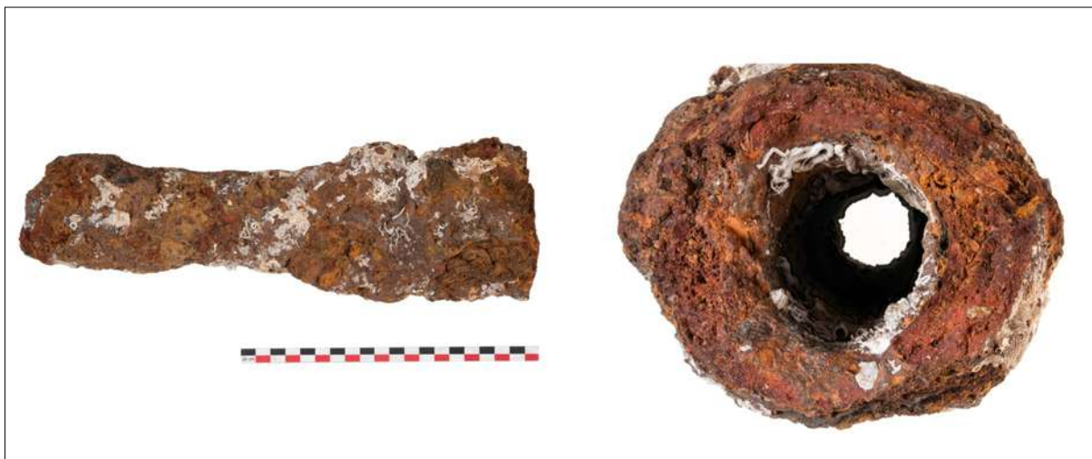
Fig. 1. Concrétion ferreuse formée autour d'une cheville en fer (élément de boulet ramé?). La concrétion est vide de tout reste d'objet. © Lisa Preud'homme/Laboratoire Arc'Antique-Grand Patrimoine de Loire-Atlantique.
