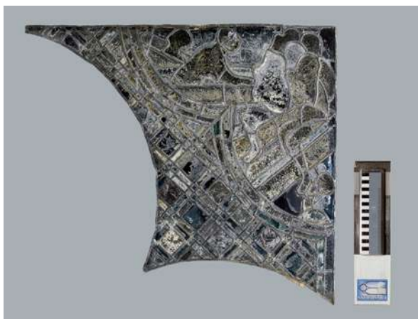
Fig. 12. Panneau de vitrail provenant de la cathédrale de Bourges, baie 4, panneau 9, début du XIII e siècle, déposé dans le cadre du projet Constglass, face externe en lumière réfléchi. On a pu observer l'état de conservation du film de protection à base de résine polyuréthane appliqué en 1981, très fissuré et soulevé, et tester sa réversibilité, qui s'est révélée bonne. © LRMH/Claudine Loisel.
