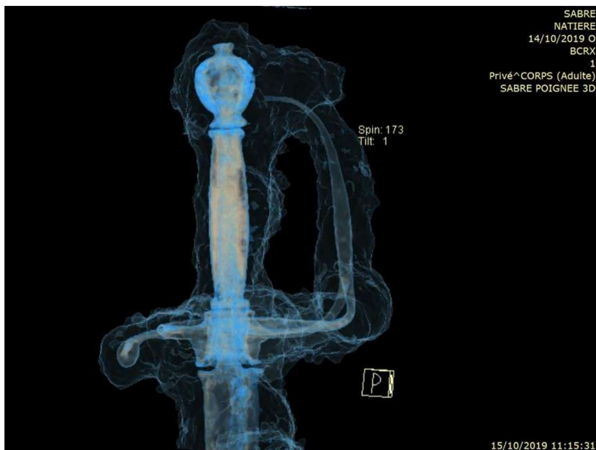
Fig. 4. Tomodesitométrie d'une gangue formée autour d'une poignée de sabre. © BCRX.
