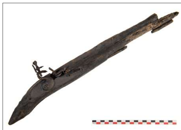
Fig. 8. Pistolet après traitement : les éléments d'armement ont été obtenus par impression 3D, alors que le canon, trop dégradé pour suivre le même processus, a été coulé. © Lisa Preud'homme/Laboratoire Arc'Antique-Grand Patrimoine de Loire-Atlantique.
