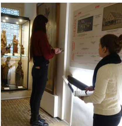
[↑] Utilisation d'un humidimètre, contre une cimaise, pour connaître la teneur en humidité de la paroi sur laquelle est exposé un panneau peint, musée Bossuet, Meaux. ©C2RMF - Jocelyn Périllat-Mercerot
