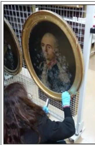
◀ ▶ Prélèvement par écouvillons stériles sur des peintures
