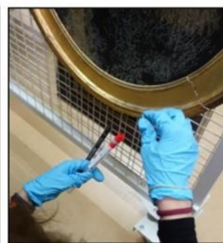
◀ ▶ Prélèvement par écouvillons stériles sur des peintures
