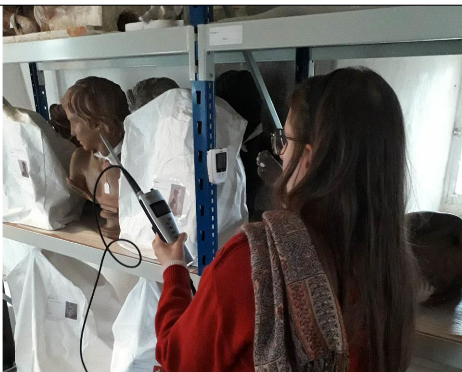
Mesure climatique à l'aide d'un thermohygromètre à sabre dans une réserve crédit photographique : Jocelyn Périllat-Mercerot, décembre 2022
