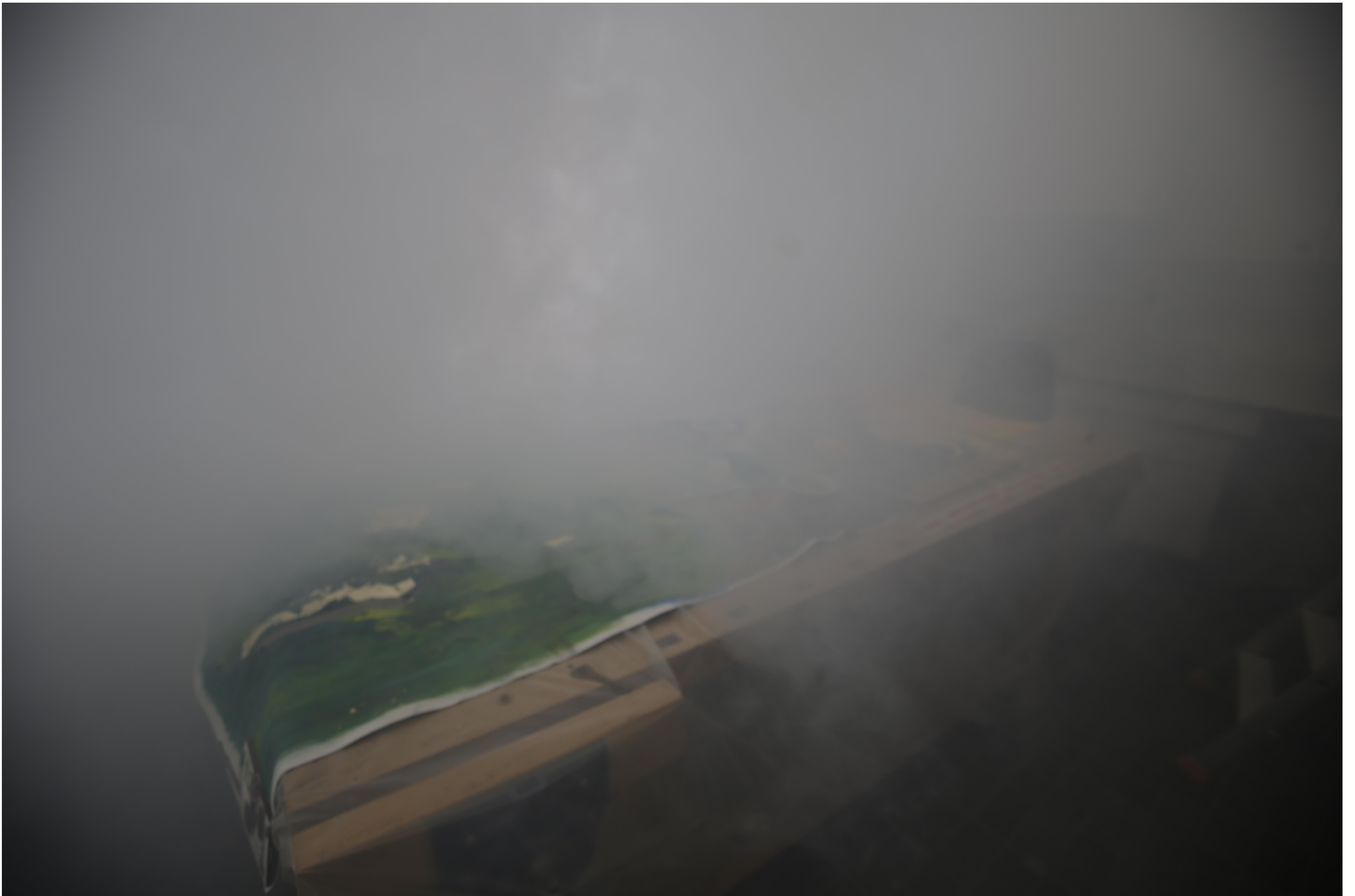
Exemple de brouillard produit à partir de propylène glycol et d'eau déminéralisée**
