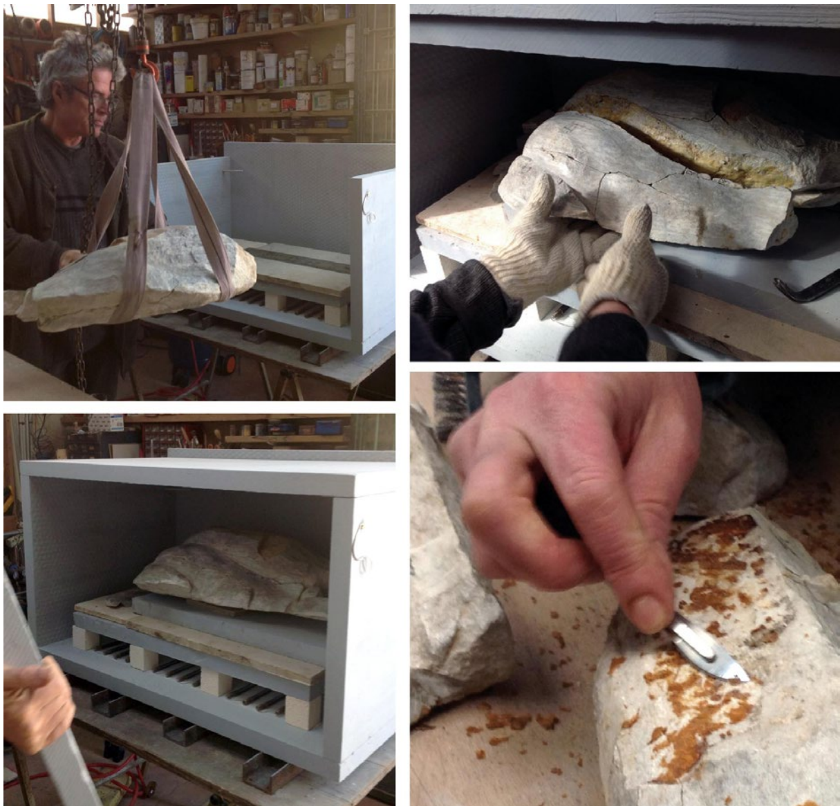
Fig. 3. Enfournement du torse, sortie de four, séparation des fragments et élimination de la colle époxy. © Sandrine et Benoit Coignard.
