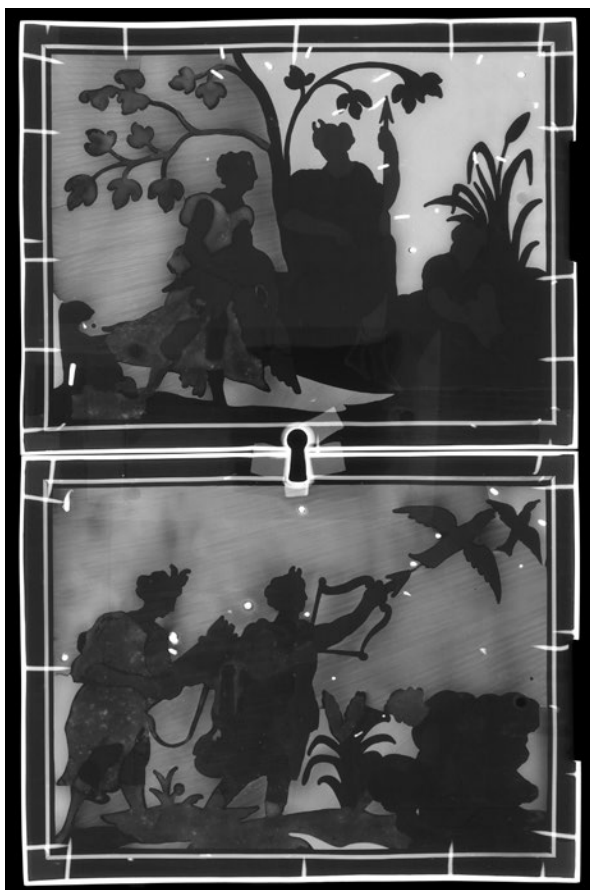
Fig. 13. Porte droite du secrétaire, radiographie à 100 kilovolts, 10 milliampères, 10 minutes avec un filtre en cuivre de 1 mm. © C2RMF/Elsa Lambert.
