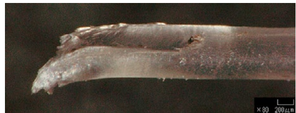
Fig. 7. Détail du fil en microscopie digitale montrant le faciès caractéristique en fourches des ruptures. © C2RMF/Gilles Barabant et Agathe Riquier.
