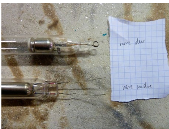
Fig. 12. Électrodes pour néon, Paris, Lycée Dorian. © C2RMF/Cécile Dazard.
