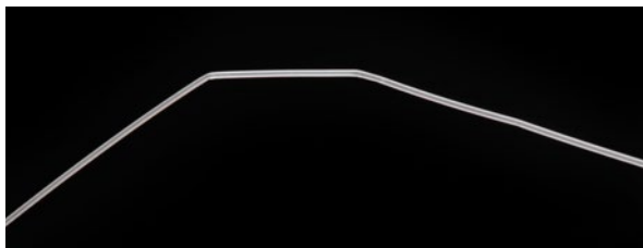
Fig. 6. Détail du fil d'origine : déformation plastique au niveau d'une encoche. © C2RMF/Thomas Clot.
