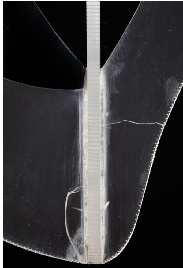
Fig. 5. Naum Gabo, Construction linéaire dans l'espace n° 2 , détail (après démontage du fil). Partie basse d'une plaque de PMMA fracturée et restaurée en 1977. © C2RMF/Thomas Clot.
