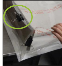
Photographie, maintien des faces par des pinces à dessin (étape n°6)
