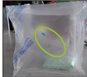
Photographies, mise en place d'un thermohygromètre et d'une bandelette anaérottest (étape n°14)
