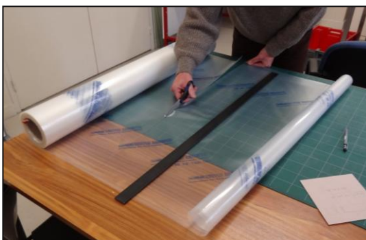
Photographie et schéma, découpe des faces de la poche d'anoxie (étape n°4)
