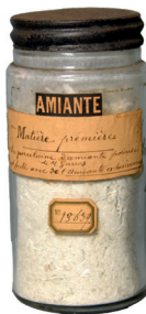
Félix Garros, Échantillon de porcelaine poreuse faite avec de l'amiante pur, Avant 1904, Amiante, Verre Fer, N° inventaire 14532-0000- © Musée des Arts et Métiers, Cnam/Denis Pruvrel
