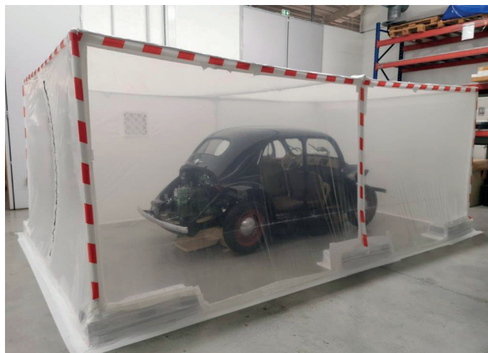
Isolement de la voiture pour réaliser le dépoussiérage et le retrait de l'amianté © Sylvie Maillard
