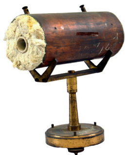
Pierre Chenevard, Four électrique cylindrique du dilatomètre différentiel enregistreur, 1916, 13x10,5x24 cm, Alliage cuivreux, Amiante, N° d'inventaire 20714-0001 © Musée des Arts et Métiers, Cnam/Denis Pruvrel
