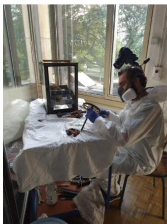
Décontamination du mécanisme horloger du Feu à éclats © Atelier Chronos
