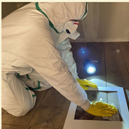
Méthode de prélèvement du plomb avec lingette
