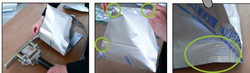
Schémas et photographies, points de soudure (étape n°7)
