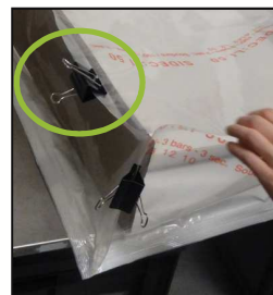
Photographie, maintien des faces par des pinces à dessin (étape n°6)
